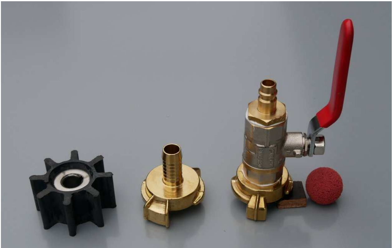
Impeller für Saftpumpe, Schlauchanschluß für Reinigung des Pasteurs mit Schwammkugel, Druckluftanschluß für Schwammkugel, Schwammkugel
